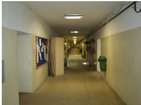
Figura 15- Circulação do segundo andar do bloco G: destaque negativo para as instalações aparentes e a iluminação mal distribuída.
