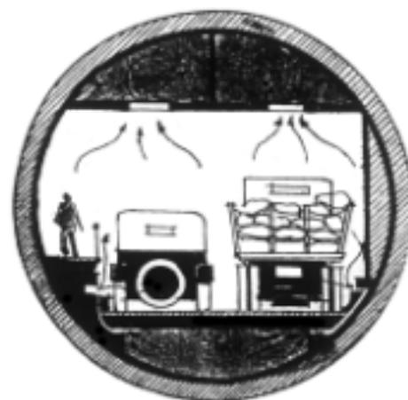
Fig. 460: Corte transversal do túnel proposto por Atílio Corrêa Lima para fazer a ligação entre o Calabouço e o Gragoatá, com o mesmo sistema de aeração utilizado no túnel entre Nova Iorque e Nova Jersey. Tese-Projeto, 1930.
