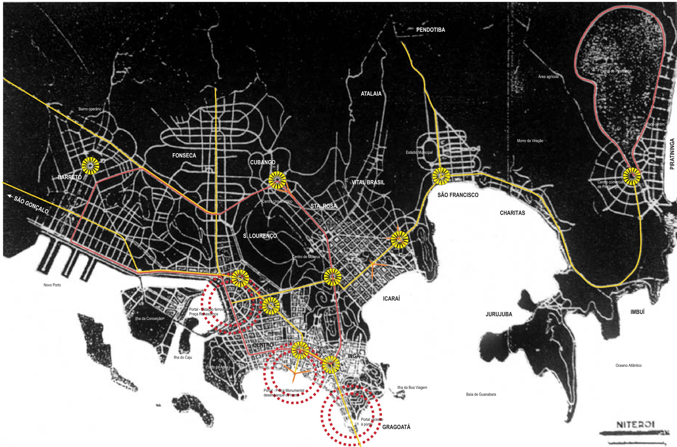
Fig. 502: Planta Geral de Remodelação da Cidade de Niterói. Atílio Corrêa Lima, 1930. Nesta planta, foram identificados alguns dos elementos analisados no capítulo 2 - os portais da cidade, as avenidas em Y, radiais e concêntricas, as praças rotatórias e o sistema de espaços livres.
